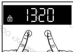
Нажмите одновременно на кнопки **+** и **-** до отображения символа **🔒** на экране. Для разблокировки удерживайте одновременно кнопки **+** и **-** до исчезновения с экрана символа **🔒**.
