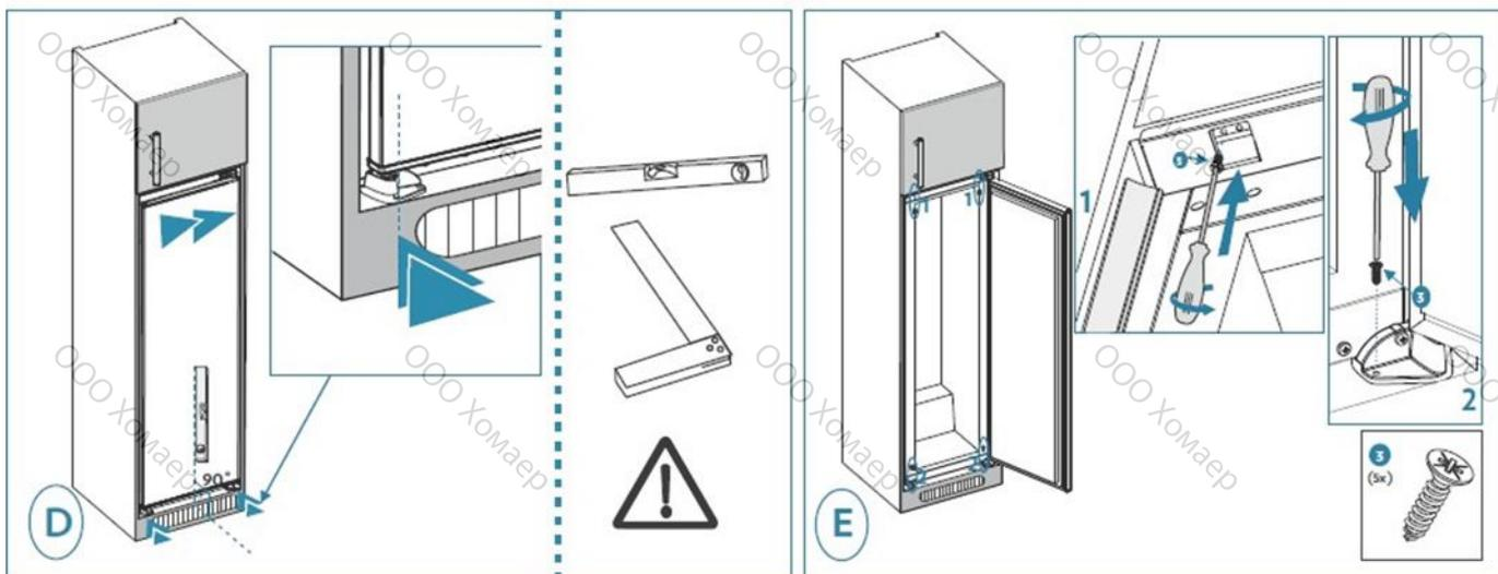
5. Привинтите направляющую в отверстия на боковой стороне устройства. Вставьте полозья в направляющую и привинтите их к дверце. Открутите направляющую, чтобы привинтить последний винт полозьев к дверце.
