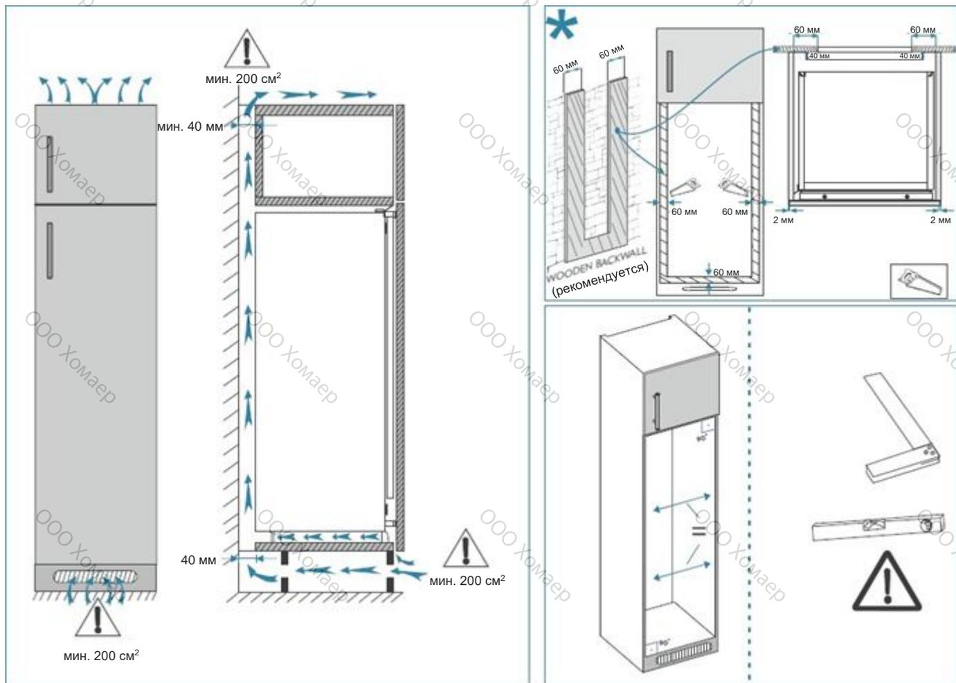
2. Установите резиновую боковую прокладку, чтобы закрыть зазор между устройством и деревянным шкафом со стороны открывания дверцы. Прикрепите опору для крепления шкафа к устройству.
