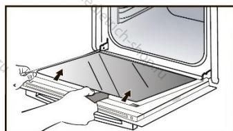
Дверца состоит из двух дополнительных стеклянных панелей с черными каучуковыми упорами по углам.
