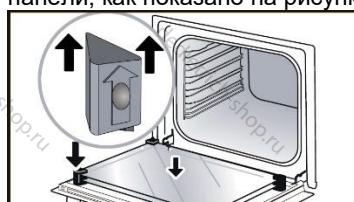
Вставьте последнюю стеклянную панель в металлические упоры, затем зафиксируйте ее так, чтобы сторона с надписью **PYROLYTIC** была обращена к вам и была читаемой.
